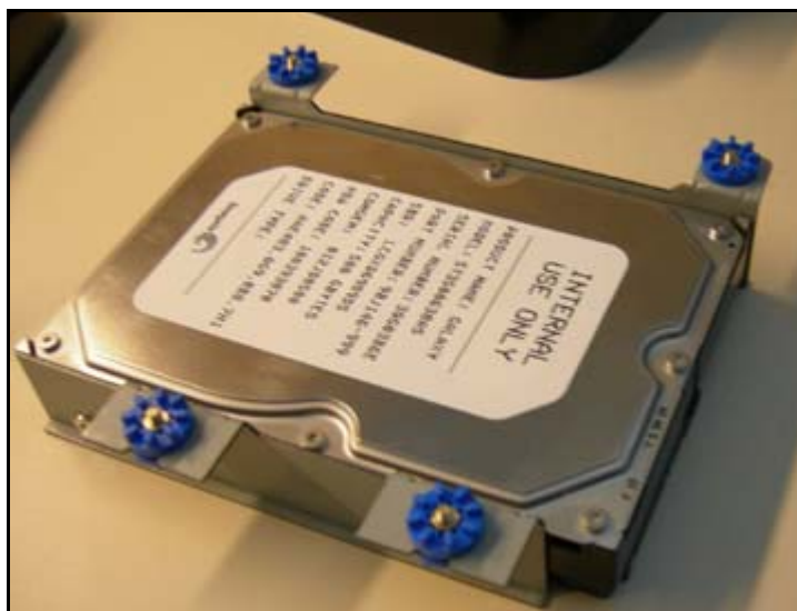
Σχήμα 132: Μονάδα δίσκου αντικατάστασης με προσαρτημένους βραχίονες
