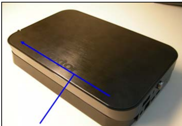
Σχήμα 136: Το κάλυμμα έχει κλειδώσει στο κάτω μέρος της μονάδας δίσκου
