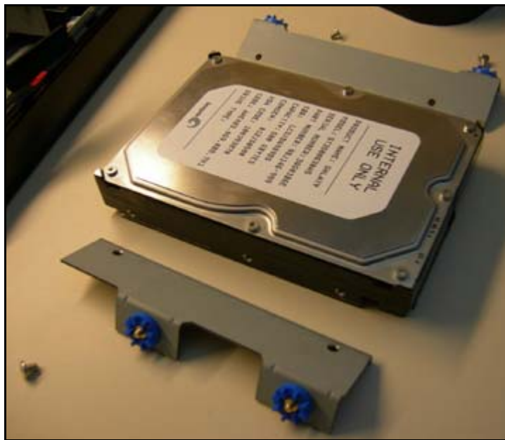
Σχήμα 131: Μονάδα δίσκου αντικατάστασης
