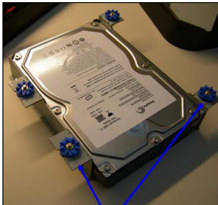
Σχήμα 129: Βραχίονες στερέωσης
